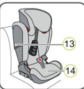
Ajuste de la inclinación del respaldo: El respaldo (13) está conectado al cojín de asiento (14) mediante un eje articulado. El respaldo (13) se regula de gradualmente y se adapta perfectamente a la inclinación del asiento del vehículo. Tenga en cuenta que la protección óptima sólo se garantiza cuando el asiento del vehículo se encuentra en posición vertical.
