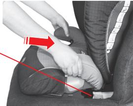
☞ Schieben Sie beide KIDFIX-Rastarme **15** in die Einführhilfen **16**, bis die KIDFIX-Rastarme **15** auf **beiden Seiten** einrasten. „KLICK!“ **Vorsicht!** Auf **beiden** Seiten muss nun der grüne Sicherungsknopf **22** sichtbar sein.
