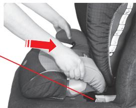
✎ Вставьте оба консольных фиксатора KIDFIX **15** в приемные приспособления **16** так, чтобы фиксаторы KIDFIX зафиксировались **15** с **обеих сторон**. "ЩЕЛК!"
