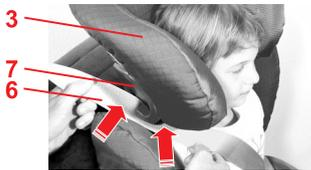
☞ Pase el cinturón diagonal **6** por el soporte de color rojo oscuro **7** del reposacabezas **3**, hasta que esté por completo en el soporte del cinturón **7** sin retorcerse.
