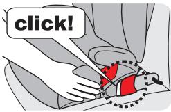
**4.3 Sposób prawidłowego zamontowania fotelika dziecięcego przy użyciu ramion zatrzaszkowych KIDFIX**
