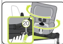
Para cambiar el sentido de marcha, pulse el botón giratorio (20) y gire el asiento en la dirección deseada hasta que encastre. En el uso en sentido de marcha, es necesario que el estribo de amortiguación (10) se encuentre en la posición vertical.
