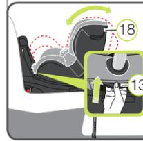
**Para ajustar el ángulo del asiento:** Desplace la palanca de ajuste (13) hacia adelante y desplace / empuje la bandeja del asiento (18) a la posición deseada.
