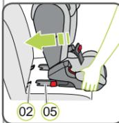
8. Placez le siège enfant dans le sens de la marche sur un siège du véhicule dont l'utilisation est autorisée. Veillez à ce que le dossier (13) repose à plat sur le dossier du siège du véhicule.
