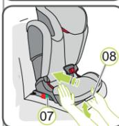
10. Faites glisser les deux bras à encliqueter ISOFIT (05) dans les guides d'insertion (02) jusqu'à ce que les bras à encliqueter ISOFIT (05) s'enclenchent avec un « clic » sonore des deux côtés.
